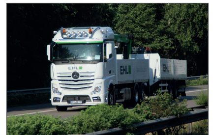
40 Tonnen Auflieger LKW mit Bordwänden; Entladung erfolgt per Ladekran
