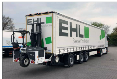
40 Tonnen LKW mit Ladefläche und Plane; Entladung erfolgt per Mitnahmestapler
