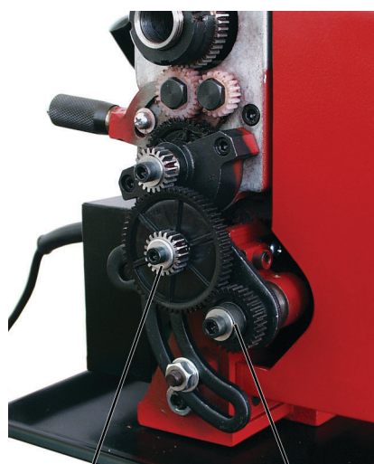
Zusätzliches Wechsel- rad vor Wechselrad B montieren
