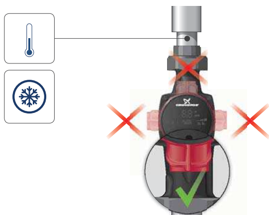
Abb. 6 Zulässige Klemmenkastenstellungen in Klimaanlage und Kaltwassersystemen
