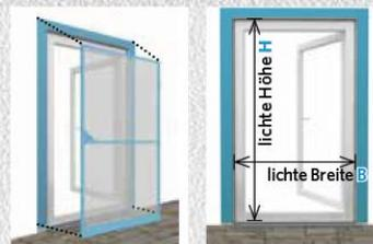
Messen Sie von Mauerwerk zu Mauerwerk.
