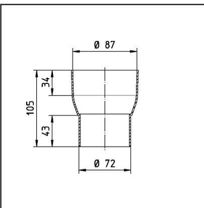
Als Übergang von 87 mm Metallfallrohre auf 75 mm Kunststofffallrohre.
