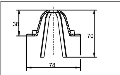
Der Laubfangkorb wird in den Stutzen der halbrunden Dachrinne eingesetzt und verhindert so eine Verstopfung des Fallrohres.
