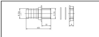
Mit dem Tonnenanschluss 1" können mehrere Regenwassertonnen miteinander verbunden werden. Die Schlüsselweite beträgt 33 mm.
