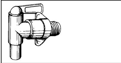
Wasserhahn mit 3/4" Außengewinde für den Anschluss an eine Wassertonne.
