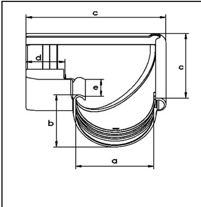
Mit der Außenecke werden (über das Nocke -Nut-System) zwei Dachrinnenenden verbunden. Bei der Montage ist die Einstecktiefe 'd' zu beachten (siehe Montage -Anleitung).
