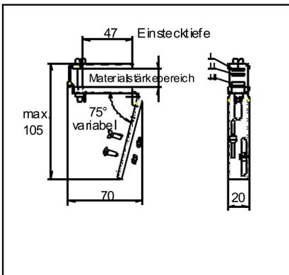
Zum Befestigen der Dachrinne bis RG 100 mit dem Rinnenhalter aus Kunststoff an Welle 8 -130/3 und Profil 76/18 (kleingewellt) und an Stegdoppelplatten. Klemm -Möglichkeit für drei Materialstärkebereiche:
