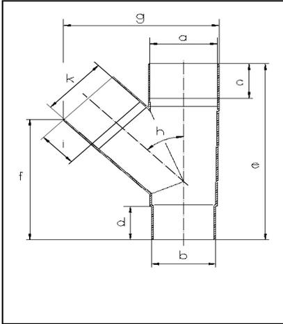
Mit den Rohrabzweigen lassen sich die Fallrohrsysteme miteinander verbinden, so dass ein seitlicher Zulauf in eine Hauptleitung möglich ist.
