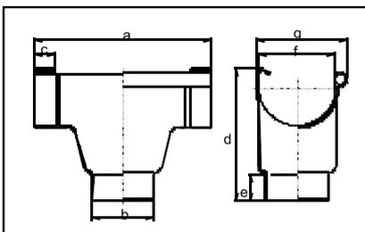
Die Dachrinne wird ungeteilt durch den Stützen geführt, wobei ein Loch für den Wasserablauf in die Dachrinne gesägt oder gebohrt wird. Der Stützen kann über eine Fallrohrmuffe mit dem Fallrohr oder direkt mit einem Bogen verbunden werden.
