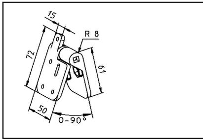
Der Verstellwinkel ist speziell für die Montage von den halbrunden Dachrinnen RG 100 und RG 125, an Block- oder Gartenhäusern mit rechtwinklig zur Dachneigung angebrachten Stirnbrettern, gedacht. Der Kunde kann so die gewünschte Halbrunddachrinne von Marley einfach und schnell an sein Blockhaus montieren kann.
