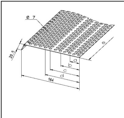
Laubfrei schützt die Dachrinne vor Laub und Verschmutzung. Bei der glatten Abdeckung der Dachrinne kann sich kein Laub festsetzen. Die Montage erfolgt mit den mitgelieferten Kunststoffklammern. An der Wulst der Dachrinne. Laubfrei kann an allen Dachrinnensystemen mit einer Wulst montiert werden. Die Markierungen auf der Unterseite dienen als Hilfe für den Zuschnitt bei kleineren Dachrinnen.
