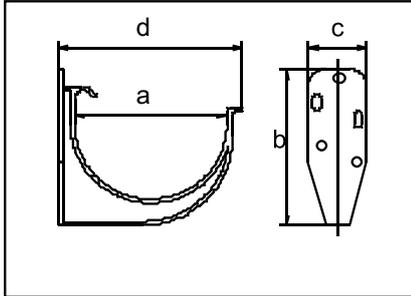
Die Rinnenhalter sind in einem Abstand zwischen 50 und 70 cm direkt am Stirnbrett zu befestigen und mit einer Richtschnur so auszurichten, dass die Dachrinne ein Gefälle von 2 bis 3 cm pro 10 m Rinnenlänge aufweist.
