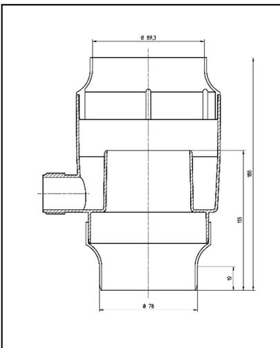
Für Fallrohre von 81 – 89 mm Außendurchmesser mit Regensammler DN 105 zu verwenden.
