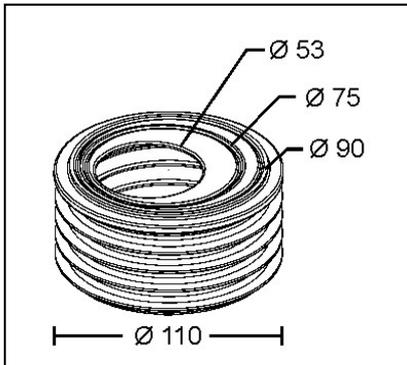
Gummimanschette für Fallrohranschlüsse an die Grundleitung (KG-Rohre DN 110). Mit der Gummimanschette können Fallrohre DN 53, DN 75, DN 90 an eine KG-Muffe oder an das KG-Spitzenende angeschlossen werden. Der Zuschnitt der erforderlichen Nennweite erfolgt mit einem Cuttermesser.
