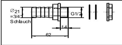
Mit dem Tonnenanschluss 3/4" können mehrere Regenwassertonnen miteinander verbunden werden. Die Schlüsselweite beträgt 27 mm.
