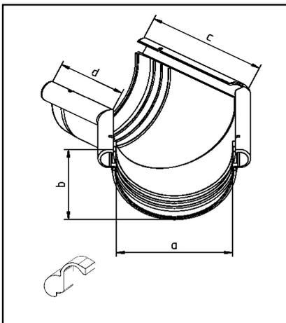
Die Sonderecke 135° kann als Innen- oder Außenecke gleichermaßen verwendet werden. Bei der Montage ist die Einstecktiefe zu beachten (siehe Montage-Anleitung). Werksseitig erfolgt die Auslieferung als Außenecke. Bei der Verwendung als Innenecke muss der Clip umgesteckt werden.
