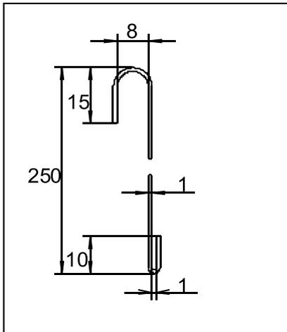
Traufstreifen für Steildach, er schützt das Bauwerk vor Regenwasser und Flugschnee und wird in Verbindung mit Rinneneisen zum Abbiegen eingesetzt. Die Feder des Rinneneisens ist zu kürzen und der Traufstreifen mit Pappnägeln zu befestigen.
