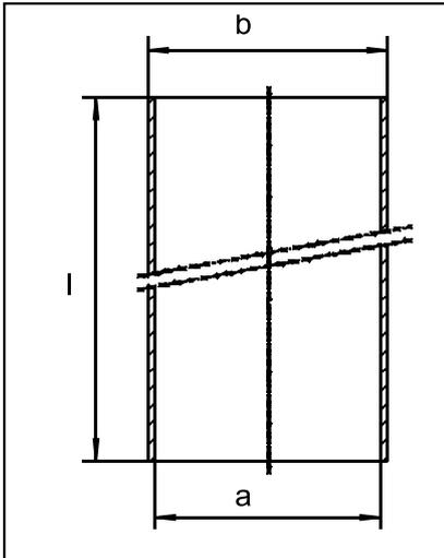
Fallrohre müssen mit einer separaten Rohrmuffe verbunden werden. Befestigung der Fallrohre mit Rohrschellen im Abstand von ca. 2m. Unter der Verbindung g immer eine Fest-Schelle setzen.
