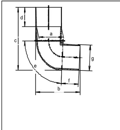
Mit Hilfe des Bogens 87° sind Verbindungen zwischen Fallrohr und Stutzen oder zwischen zwei Fallrohren möglich. Zur Verbindung von zwei Bögen muss ein Fallrohrstück oder der Bogenverbinder zwischengesetzt werden.
