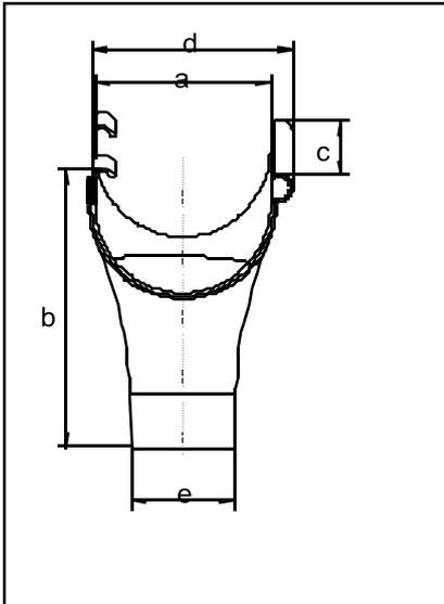
Die Dachrinne wird ungeteilt durch den Stützen geführt, wobei ein Loch für den Wasserablauf in die Dachrinne gesägt oder gebohrt wird. Der Stützen kann über eine Fallrohrmuffe mit dem Fallrohr oder direkt mit einem Bogen verbunden werden.
