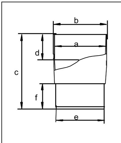
Mit Hilfe der Rohrmuffe sind Verbindungen zwischen Fallrohr und Stutzen oder zwischen zwei Fallrohren möglich.
