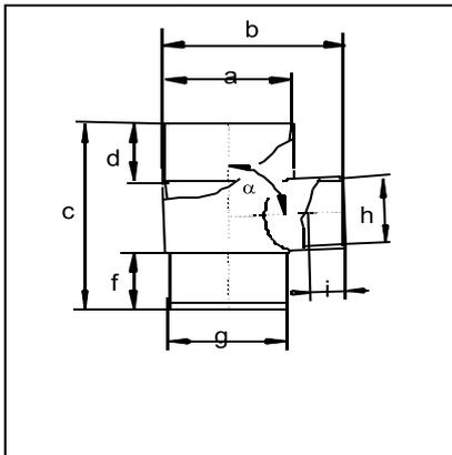
Mit den Rohrabzweigen lassen sich die Fallrohrsysteme miteinander verbinden, so dass ein seitlicher Zulauf in eine Hauptleitung möglich ist.
