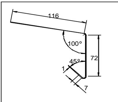
Diese Winkelausführung eignet sich ebenfalls beim Steildach in Verbindung mit verstellbaren Rinneneisen. Der Traufstreifen ragt dabei in die Dachrinne hinein. Die Feder des Rinneneisens ist zu kürzen und der Traufstreifen mit Pappnägeln zu befestigen.
