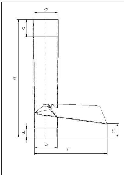
Die Wasserablaufklappe wird ohne Zusatzteile in ein Fallrohr eingebaut. Bei nachträglicher Montage ist in der gewünschten Höhe ein entsprechend langes Fallrohr -Segment herauszuschneiden. Durch Schwenken der Klappe (nach oben oder unten) wird das Regenwasser in die Kanalisation oder z.B. eine Tonne geleitet .
