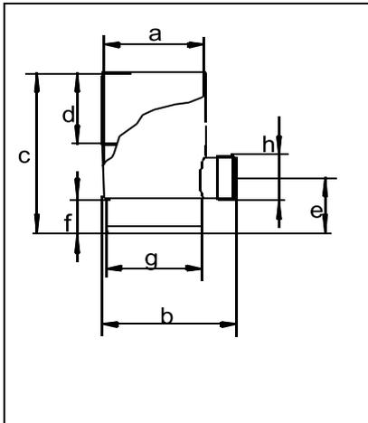
Mit Hilfe der Anreißschablone wird der Ausschnitt am Regenfallrohr angezeichnet und herausgesägt. Der Regensammler wird mit Dichtungen in das Fallrohr eingebaut (siehe beiliegende Montage-Anleitung).
