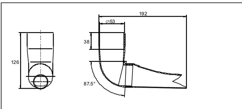
Der Speier lässt sich direkt am Stutzen oder dem Fallrohr DN 53 anbringen. Er muss mit dem Stutzen verklebt werden.
