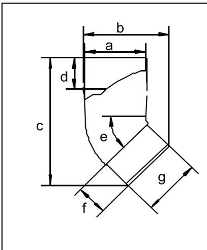
Mit Hilfe des Bogens 45° sind Verbindungen zwischen Fallrohr und Stützen oder zwischen zwei Fallrohren möglich. Zur Verbindung von zwei Bögen muss ein Fallrohrstück oder der Bogenverbinder zwischengesetzt werden.
