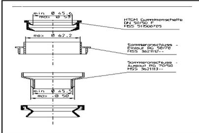
Für Fallrohre von 46,6 – 62,5 mm Außendurchmesser ser zu verwenden. Am unteren Übergang die Dichtung vom Regensammler RG 75 verwenden.
