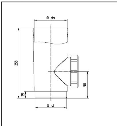
Reinigungsrohr für Fallrohrsystem DN 105 als Kontroll- und Reinigungsöffnung für Fallrohre. Mit leicht abschraubbar em Deckel.
