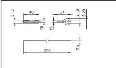
Die Verlängerung wird zusammen mit einer Fallrohrschelle montiert. Der Einsatzbereich sind Häuser mit einer zusätzlichen Wärmedämmung.
