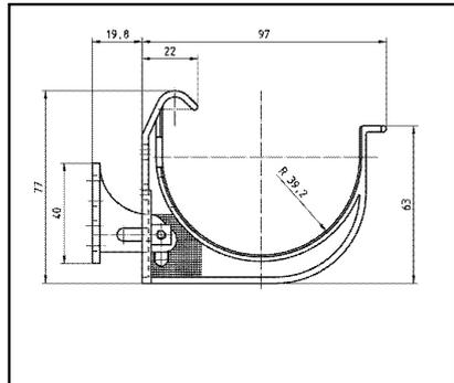
Der verstellbare Rinnenhalter ist in einem Abstand zwischen 50 und 70 cm direkt am Stirnbrett zu befestigen und mit einer Richtschnur so auszurichten, dass die Dachrinne ein Gefälle von 2 bis 3 cm pro 10 m Rinnenlänge aufweist. Der Rinnenhalter kann in einem Bereich bis 25° geneigt werden.
