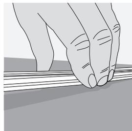
**2.** Legen Sie die Leiste mit dem Kleber nach unten auf den Boden und drücken Sie sie fest an. Entscheiden Sie in welche Richtung die Nut des LED-Streifens ausgerichtet wird. Alle weiteren Leisten müssen in der gleichen Richtung ausgelegt sein.
