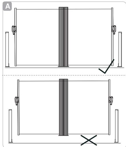
**Hinweis:** Achten Sie darauf, dass der Haltpfosten 5 in einem festen Untergrund (Holz, Stein) montiert werden muss. Andernfalls findet der Haltpfosten 5 keinen festen Halt.
