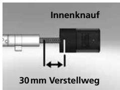
Schematische Darstellung Innenknopf-Verstellung
