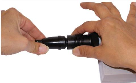
4.4 Verschieben Sie die Abdeckkappe, um den Stecker der schwimmenden Drehgelenkdurchführung zu berühren.
