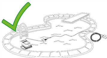
4.11 Für optimale Reinigungsergebnisse geben Sie ausreichend Schwimmkabel ins Becken, aber nie mehr als nötig, um jede Stelle im Becken zu erreichen. Begrenzen Sie die Länge des Kabels in den Pool auf ein Minimum und platzieren Sie das überschüssige Kabel außerhalb des Beckens.
