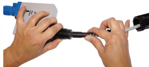
4.3 Stecken Sie das Ende des vom Transformator kommenden Schwimmkabels in die schwarze "POWER"-Buchse. Achten Sie auf die Ausrichtung des Steckers.
