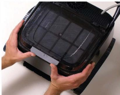
6.1 Um an den Filterkorb zu gelangen, setzen Sie die Hände, wie in der Abbildung an um das Gehäuse zu entsichern.
