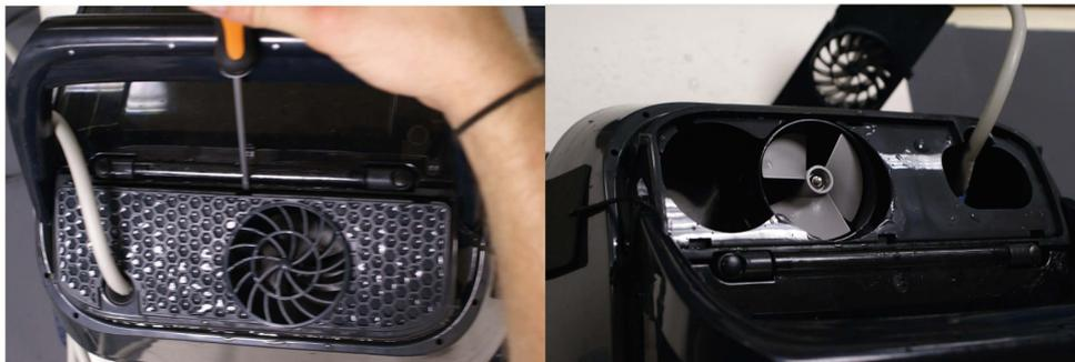
7.1. Das Schutzgitter entfernen Sie mit einem flachen Schraubenzieher.
