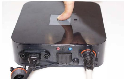
4.10 Drücken Sie den Ein-/Aus-Schalter oberhalb des Transformators, um den Reiniger einzuschalten. Es erscheint ein rotes Licht. Am Ende des Reinigungszyklus schaltet sich das rote Licht ab.
