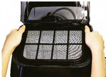
6.5 Nach der Reinigung, den Korb wieder in den Roboter einsetzen. Wenn der Korb nicht richtig ausgerichtet ist, ist es nicht möglich, die Abdeckung des Reinigers zu schließen.
