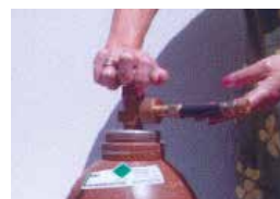
7 Handrad vom Flaschen-Absperrventil schließen
