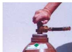
3 Handrad vom Flaschen-Absperrventil öffnen
