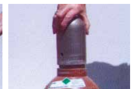
10 Flaschenkappe wieder aufschrauben
