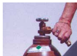
8 Ballongasventil nochmals ab-winkeln, damit Restgas entweichen kann
