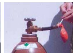
4 Schnellverschluss und Ballon über das Ballongasventil ziehen
