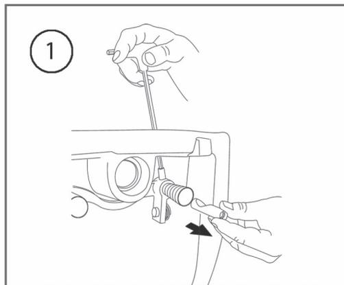
Entfernen Sie mit Hilfe eines Inbusschlüssels die 2 Trägerbolzen (5) durch lösen der beiden Fixierschrauben (4), jedoch nicht ganz herausdrehen. **Entfernen Sie keinesfalls die Kunststoffhülsen** (sie dienen zum leichteren draufschieben des WC auf die Trägerbolzen)
