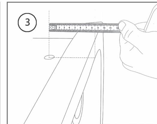
Messen Sie den Lochabstand der Bohrungen zum hinteren Abschluss des WC.
