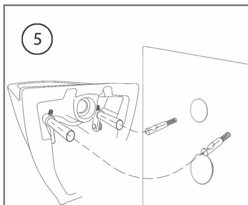
Setzen Sie das WC vorsichtig auf die Wand-Trägerschrauben und schieben Sie es bis zur Wand. Die Kunststoff-Führungshülsen erleichtern diesen Schritt.
