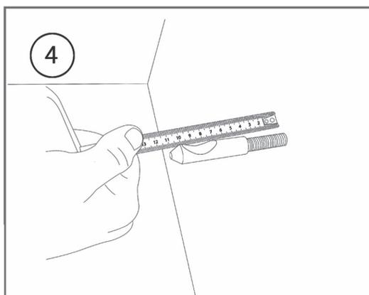
Schrauben Sie die Trägerbolzen so weit auf die Wandschrauben, dass der **tiefste Punkt der Vertiefung dem vorher gemessenen Wert entspricht (max. 0 bis 5mm weniger)**. Die Vertiefung muss zum Schluss nach oben zeigen !!!
