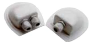
Die Kabeldurchführungen bestehen aus weißem Kunststoff. Sie werden auf der Montagefläche aufgeklebt und sind aufgrund ihrer UV- und Witterungsbeständigkeit für den Außenbereich geeignet. Die Kabelverschraubungen dichten das durchzuführende Kabel so ab, dass keine Feuchtigkeit in das Gehäuse eindringen kann.
