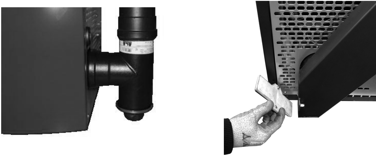
Fig. 84 - Limpieza canal de humos
