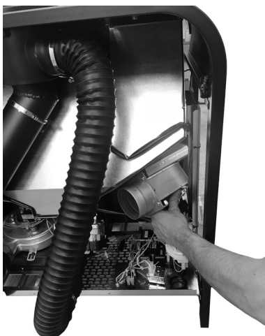
Fig. 46 - Fije el cárter y el ventilador a la estufa
