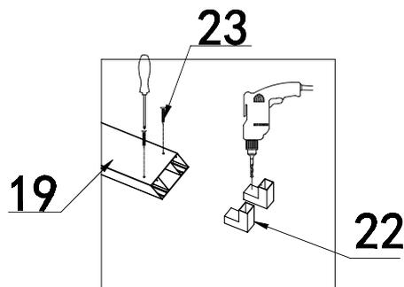
Führen Sie als Erstes die Verbindungsstücke in die dafür vorgesehenen Löcher und bohren Sie anschließend die Löcher.
