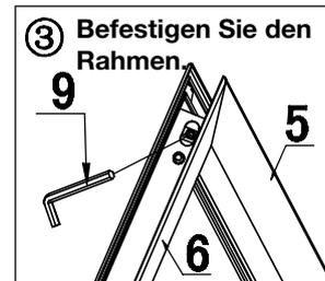
Befestigen Sie den Türrahmen mit der Türverbindung und dem Sechskantschlüssel.
