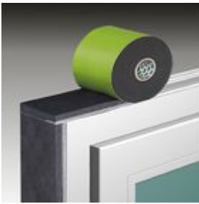
Bild 3: TP652 auf den Rahmen kleben - Seite mit der grauen Stufe nach Innen. An den Ecken überstehen lassen.
