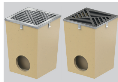
Links: Hofablauf aus Polymerbeton, mit Aufsteckzarge und Maschenrost, Stahl verzinkt, mit Kunststoff-Schmutzeimer, mit Öffnung DN 100 und herausnehmbarem Geruchsverschluss Rechts: Hofablauf aus Polymerbeton, mit Aufsteckzarge, Stahl verzinkt, und Gussrost, mit Kunststoff-Schmutzeimer, mit Öffnung DN 100 und herausnehmbarem Geruchsverschluss
