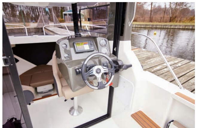
Patentiert und pfiffig: Die verschiebbare Fahrerconsole bietet dem Skipper maximale Flexibilität.
