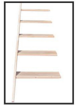
3. Stufen verschrauben und verleimen
