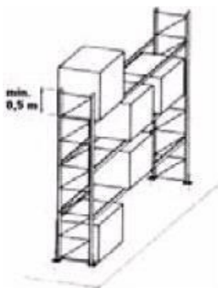
Abb. 7: Beispiel einer Sicherung gegen seitliches Herabfallen der Ladeeinheiten.
