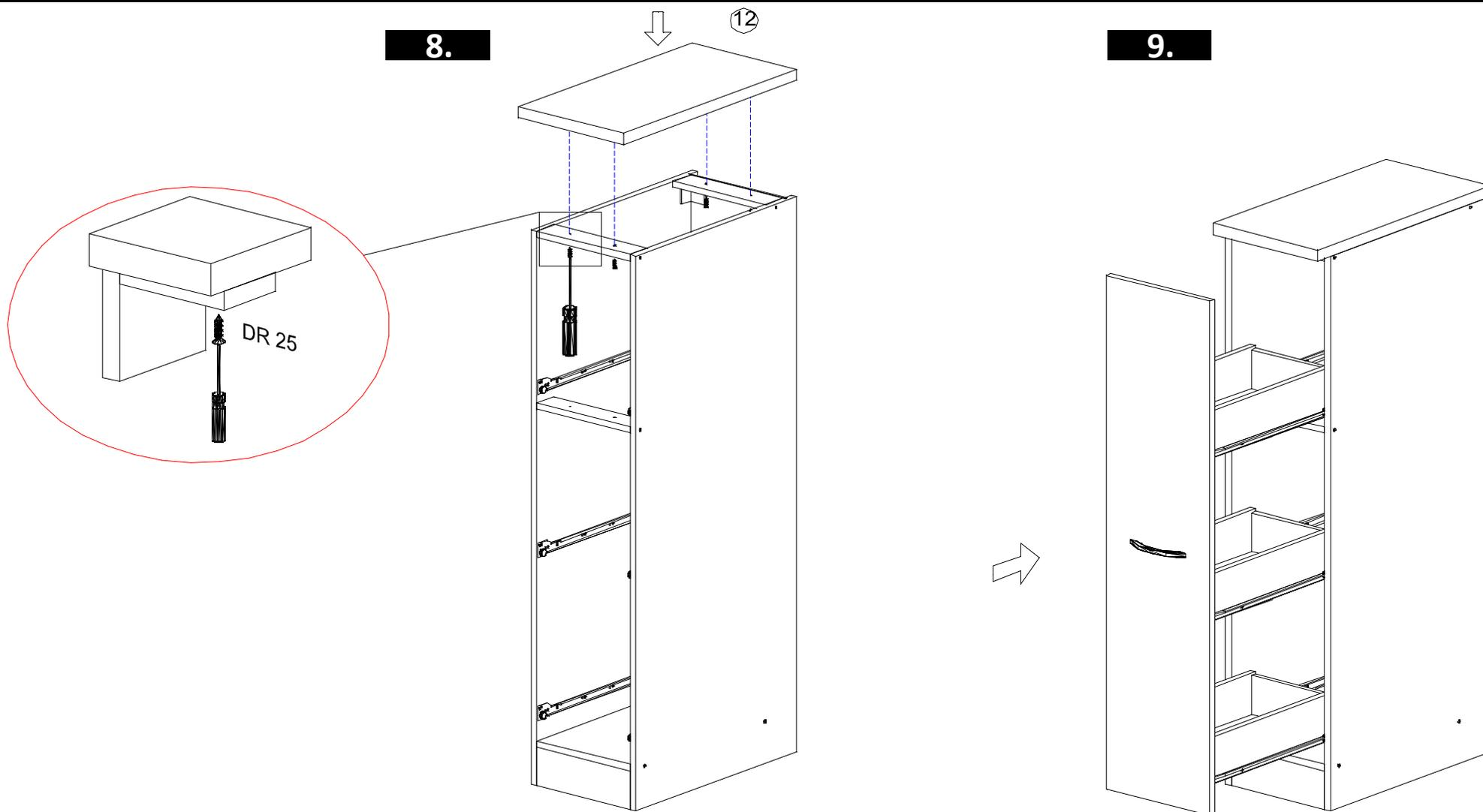
Falls beim Ausziehen die Tür nicht leicht genug funktioniert bitte die Schrauben DR25 lösen. Beginnen Sie mit der mittleren Schublade.
