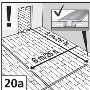
Bei Verlegeflächen mit mehr als 8 m Länge bzw. Breite und bei stark verwinkelten Räumen sind Dehnungsfugen (mind. 2 cm Breite) erforderlich [20]. Nur dann kann sich der Boden bei klimatischen Änderungen entsprechend ausdehnen oder zusammenziehen. Beachten Sie dies auch bei einer raumübergreifenden Verlegung. Hier müssen die Flächen im Türzargenbereich unterbrochen werden. Bewegungsfugen können mit entsprechenden Profilen fachgerecht abgedeckt werden.
