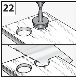
Für Heizungsrohre müssen Lochbohrungen, die 3 cm größer sind als der Rohrdurchmesser, ausgespart werden. „Einpassstück“ aussägen, beleimen, einpassen und mit einem Keil bis zur Aushärtung des Leimes fixieren. Anschließend Aussparungen mit Heizkörpermanschetten verkleiden [21, 22, 23].
