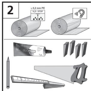
**Vorbereitung:** Bitte lagern Sie die Pakete 48 Stunden vor der Verlegung unter gleichen klimatischen Bedingungen, wie bei der Verlegung [1]. Wichtige Voraussetzung für den Einbau und eine lange Werterhaltung des Laminatbodens ist ein Raumklima mit ca. 20°C und einer relativen Luftfeuchtigkeit von 50 – 70%.
