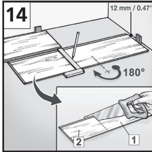
Die Verlegung in der linken Raumecke beginnen. Das erste Paneel mit der Federseite zur Wand legen und mit Abstandskeilen den Randabstand sichern. Unbedingt einen 12 – 15 mm Randabstand (Dehnungsfuge) zur Wand, Heizungsrohren, Pfeilern, Türstoppern etc. einhalten [12].
