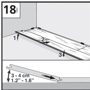
Das Paneelstück der zweiten Reihe so anlegen, dass die Paneele-Längsseiten der 1. und der 2. Reihe parallel übereinander liegen aber nicht eingeklickt sind [16]. D.h. die Federseite der 2. Reihe liegt auf der Nutseite der 1. Reihe. Vor dem Einklicken weitere Paneele bis zum Ende der 2. Reihe anlegen. Hierbei wie in der 1. Reihe vorgehen [17].
