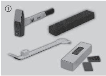
Verlegewerkzeug: Schlagklotz, Abstandskeile, Montageeisen, Hammer (mindestens 800 g), Bleistift; zum Absägen genügt eine einfache Handsäge.
