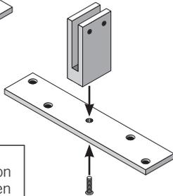
**!** Bei Standfüßen: PVC Hemmfüße von unten in Bohrungen einsetzen
