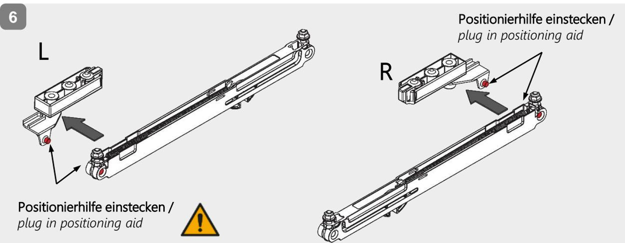
Bei der Montage des Softeinzuges ist strikt darauf zu achten, dass die Positionierhilfe mit dem Stopper fest verbunden ist, und dass der Zapfen der Positionierhilfe in der endseitigen Bohrung der Dämpfereinrichtung einsitzt, sodass in einer Endstellung des Türflügels der Dämpfer vollständig eingefahren ist.
