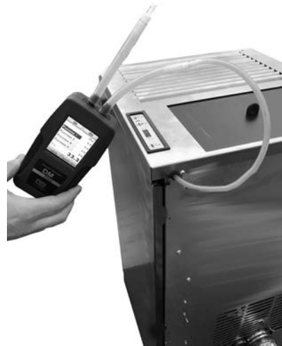
Fig. 26 - Anschluss des Digitaldruckwächters
