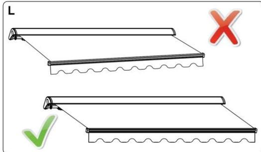
☞ Wenn Armgelenke sich nicht auf gleicher Höhe befinden, können Sie die obere Sicherungsschraube noch einmal festziehen (siehe Abb. M).
