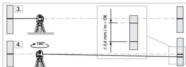
! Якщо A2 і A3 розрізняються більше ніж на  $0,4 \text{ мм} / \text{м}$ , потрібне калібрування. Зверніться до крамниці чи в сервісний відділ UMAREX-LASERLINER.
