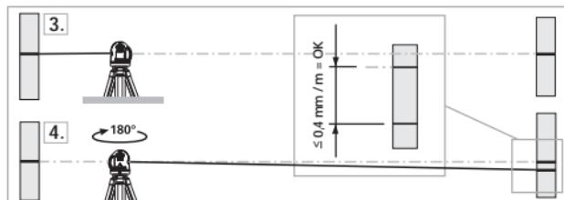
! Dacă A2 și A3 se află la o distanță mai mare de 0,4 mm / m, trebuie efectuată o calibrare. Contactați un comerciant specializat și adresați-vă departamentului service UMAREX-LASERLINER.
