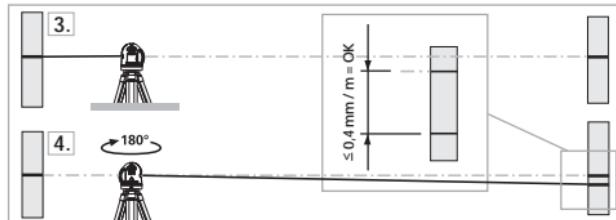
! Wanneer het verschil tussen punt A2 en A3 groter is dan de aangegeven tolerantie, nl. 0,4 mm / m, is een kalibratie nodig. Neem hiervoor contact op met uw vakhandelaar of met de serviceafdeling van UMAREX-LASERLINER.
