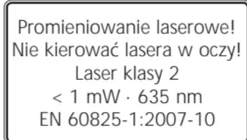
**UWAGA:** Nie kierować lasera w oczy! Laser nie może być zasięgu rąk dzieci. Nie kierować niepotrzebnie lasera w kierunku ludzi. Urządzenie zawiera wysokiej jakości laser, który jest skalibrowany w fabryce, jednak należy każdorazowo sprawdzać przed ważnym pomiarem, po transporcie, długim składowaniu dokładność kalibracji. Dokładna kalibracja jest możliwa jedynie w serwisie. Kalibracja wykonana samodzielnie zależy od staranności jej wykonania.
