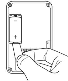
Vor jedem Verbindungsversuch mit der Thombox, vergewissern Sie sich, dass Sie den Plastikstreifen der die Batterie schützt, entfernt haben. Während der Verbindung werden Sie aufgefordert, das Gerät in den Verbindungsmodus zu setzen :
