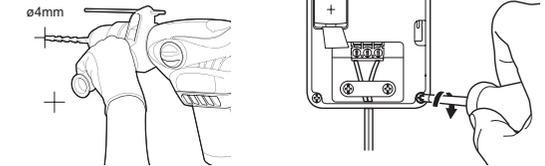
Befestigen Sie den Sender mit doppelseitigem Klebeband oder mit angemessenen Dübel und Schrauben. Die mitgelieferten Befestigungen sind nur für Betonwände geeignet.
