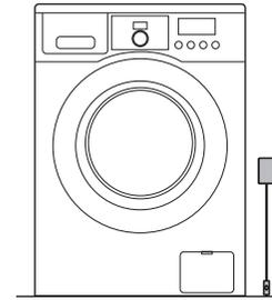
Der Bodenmelder sollte so nahe wie möglich an der potentiellen Überschwemmungsquelle angebracht werden.
