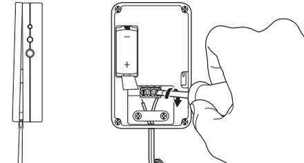
Befestigen Sie die Halterung des Melders mit angemessenen Dübel und Schrauben. Wir empfehlen eine Kreuzschraube von Ø4mm und 30mm Länge.
