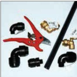
1 Benötigte Rohre und Fittings nach Ihrem Plan zusammenstellen. Die Verbindung zu bestehenden Rohrsystemen erfolgt mit Anschlussverschraubungen.
