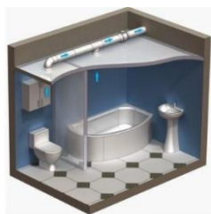
Montaje en paralelo
