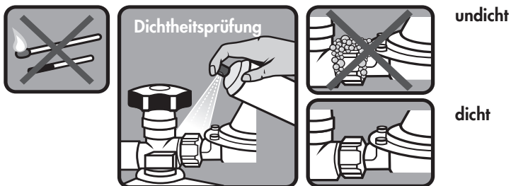
Abb. 2: Dichtheitsprüfung
