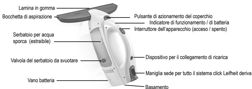
Figura 2: Dispositivi di comando del puliscivetri
