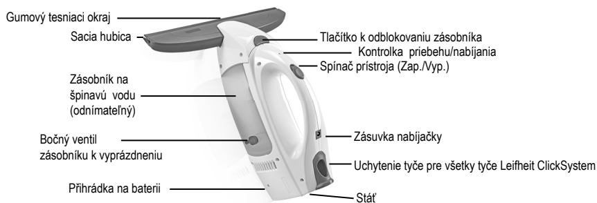
Obrázok 2: Obslužné prvky okennej odsávačky
