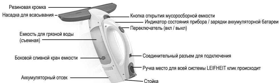
Рисунок 2: Элементы управления оконным пылесосом
