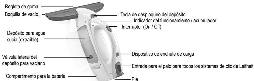
Imagen 2: elementos de control del aspirador de ventanas
