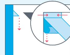
Das Abdichtband an der Wand entlang ausrichten, Druck ausüben und Trennfolie langsam entfernen.
