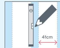
Verwenden Sie die Cristalgrip Wasserwaage, um eine ebene Linie zu gewährleisten, zeichnen Sie eine Bleistiftrichtlinie für die Position des Abdichtbandes.
