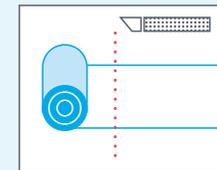
Rollen Sie das Abdichtband auf einer ebenen, sauberen Fläche ab und schneiden Sie es mit einem Messer zurecht.
