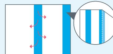
Mit der Hand das Abdichtband mit einer schwingvollen Bewegung glätten.
