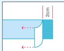
Ziehen Sie einen kleinen Abschnitt der Trennfolie zurück, um die Klebeseite freizulegen. Die Mitte des Bandes ist vorgekerbt, um das Einpassen in die Ecken zu erleichtern.
