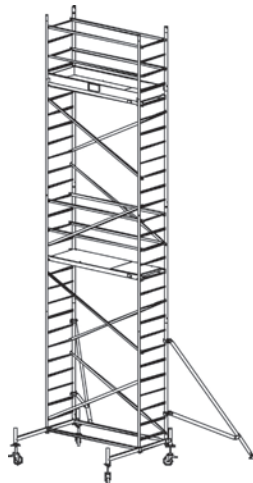
Baugruppennr. Arbeitshöhe: 8,30 m 2206 Gerüsthöhe: 7,30 m Artikel Nr. Standhöhe: 6,30 m 910165 xxxxxx
