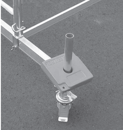
Ballastierung der Traversen
