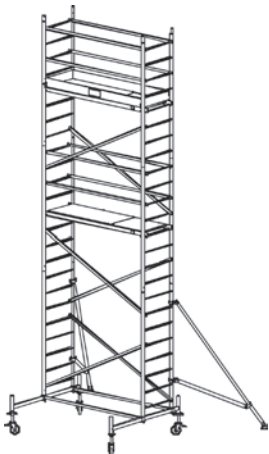
Baugruppennr. Arbeitshöhe: 7,30 m 2205 Gerüsthöhe: 6,30 m Artikel Nr. Standhöhe: 5,30 m 910158 xxxxxx
