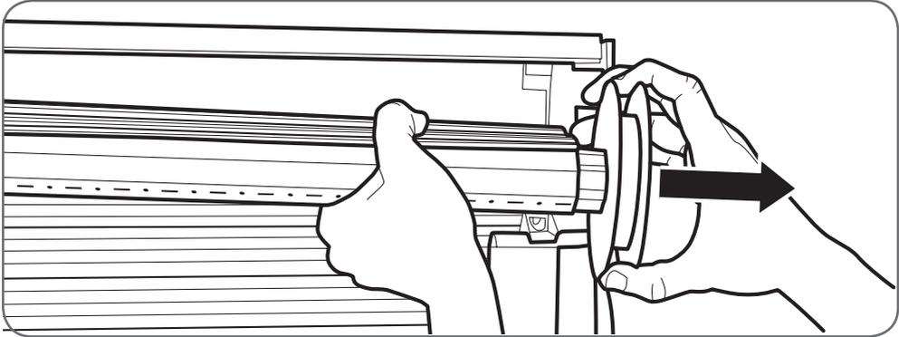
An der Seitenplatte des Kastens wird die Ankerplatte des Motors angebracht. Beseitigen Sie alle Hindernisse, um eine ebene Oberfläche zu erhalten. Bei Bedarf verstärken.
