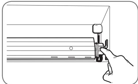
Mit jedem Drücken fährt der Rollladen weiter herab, so lange die Taste gehalten wird. Wenn der Rollladen vollkommen geschlossen ist, auf der Fernbedienung die Einschaltaste des Kanals verwenden, den Sie für die Zuordnung verwendet haben (Taste **"ON"**). Die aktuelle Position des Rollladens wird als untere Endlage gespeichert, die Einstellung ist beendet.
