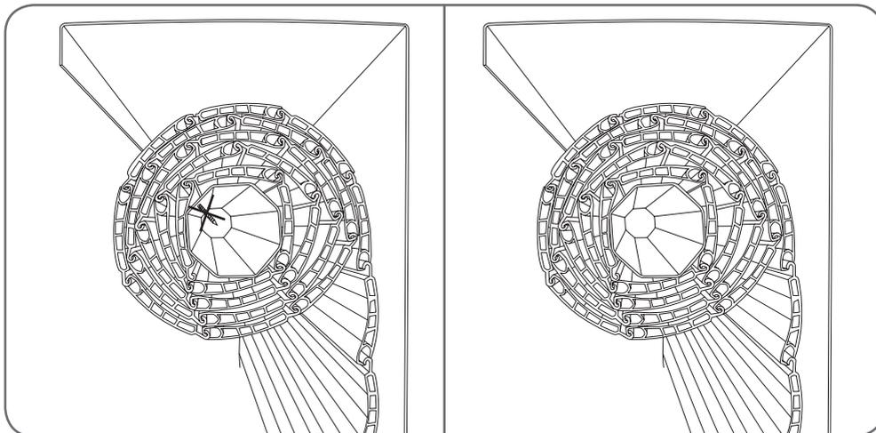
Schieben Sie den Motor so weit wie möglich in das Rohr. Der Kranz muss so weit wie möglich in das Endstück des Rohrs geschoben werden.
