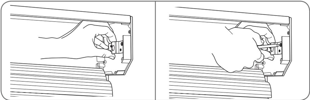
Die Achse des Drehzapfens lokalisieren, der durch den Motor ersetzt werden soll, dann die Ankerplatte des Motors positionieren, indem sie auf die Achse ausgerichtet wird.
