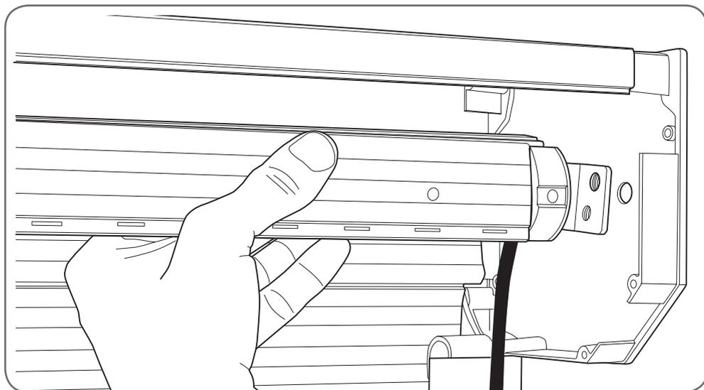
Befestigen Sie die Verankerungsplatte an der Seiteplatte des Kastens.
