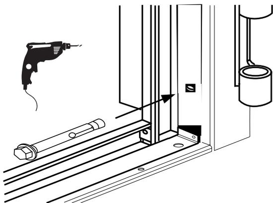
Erforderliche Bohrungen für die Dübelbefestigung in der Wand vornehmen, wobei die Stanzungen in der Zarge als Schablone verwendet werden können. Mittels bauaufsichtlich zugelassener Dübel, ( $\varnothing$  10, Länge 112 mm) und Schrauben befestigen.
