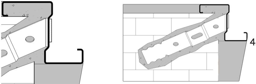
Zarge mit Zementmörtel vollständig hinterfüllen und auf der Schließseite bündig einputzen. (siehe Abb. 4)
