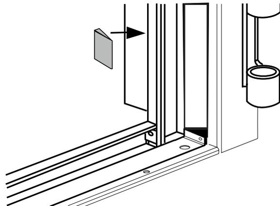
Zarge in die Wandöffnung einsetzen sowie höhenrichtig verwindungsfrei einrichten und fixieren. Hierzu Distanzhalter (nicht im Lieferumfang enthalten) vorzugsweise auf Höhe der Stanzungen platzieren. Rechtwinkligkeit (gleiche Diagonalen) prüfen.
