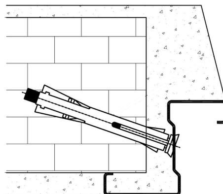
Zarge mit Zementmörtel hinterfüllen und auf der Schließseite einzuputzen.
