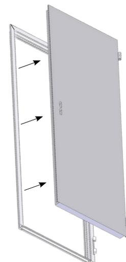
Achtung! Bei der Türblattdemontage Türelement gegen Umfallen sichern. Bandbolzen ausschlagen.
