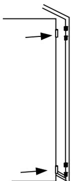
Türblatt in der Zarge positionieren, sowie obere und untere Türblattbandteile in Zargenbandteile einhängen.
