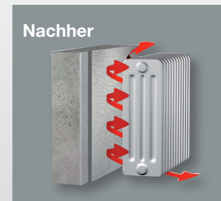
Gedämmte Heizkörpernische; kaum Energieverlust
