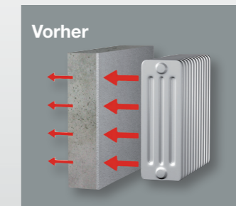
Ungedämmte Heizkörpernische; hoher Energieverlust
