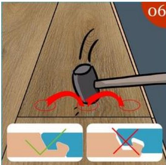
Mithilfe des weißen Gummi Hammers und 3 leichten Schlägen wie auf dem Bild dargestellt rastet das Klick-System ein.
