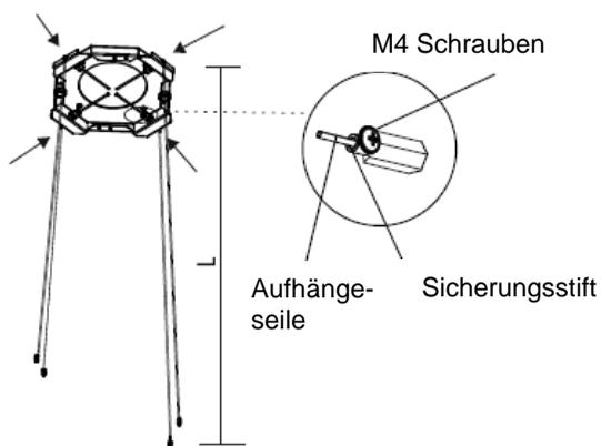
7. Führen Sie die vier Seile durch die Halterungen der Dekorplatte.
