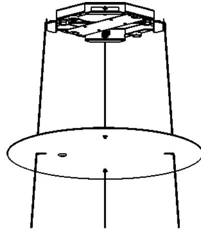
8. Führen Sie die vier Seile durch die Öffnungen mit dem schmalen Schlitz in der Haube und schieben Sie sie in die schmalen Schlitze, wie in Abb. 14 gezeigt.
