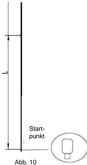
**HINWEIS:** Die Höhe der Unterseite des Haubengehäuses muss mindestens 600 mm\* bis maximal 800 mm betragen.
