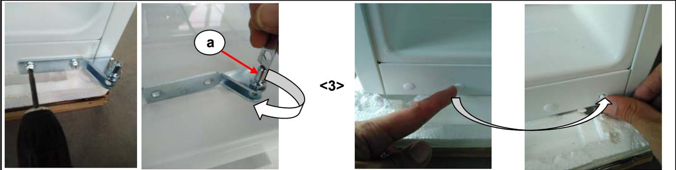
Demontieren Sie das untere Scharnier rechts. Entfernen Sie den Bolzen (a) vom Scharnier und schrauben sie ihn auf der unteren Seite fest.
