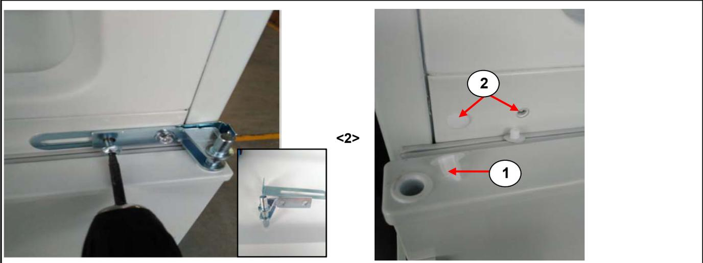
Demontieren Sie das mittlere Scharnier rechts.
