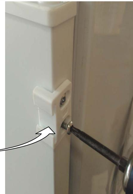
Demontieren Sie die Möbeltürgleiter links an den Türen und montieren Sie diese auf der gegenüberliegenden Seite.
