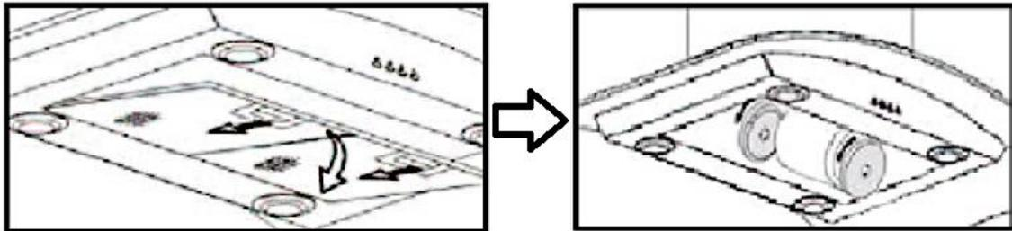
2. Die KOHLEFILTER werden auf den **beiden Seiten** des Motors befestigt (s. oben; rechte Abb.).
