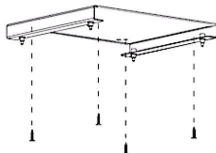
3. Verbinden Sie die Dekorplatte mit der Befestigungsplatte unter Verwendung der entsprechenden Schrauben: 2\*ST4 (8 mm).
