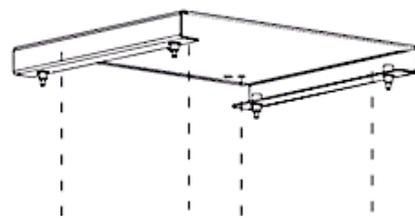
2. Nachdem Sie das geeignete Befestigungsmaterial (Dübel, Verankerungen etc.) in die Decke eingebracht und sicher befestigt haben, schrauben Sie die Befestigungsplatte fest.
