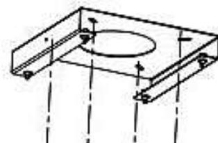
2. Nachdem Sie das geeignete Befestigungsmaterial (Dübel, Verankerungen etc.) in die Decke eingebracht und sicher befestigt haben, schrauben Sie die Befestigungsplatte fest.
