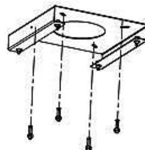
3. Verbinden Sie die Dekorplatte mit der Befestigungsplatte unter Verwendung der entsprechenden Schrauben: 2\*ST4 (8 mm).
