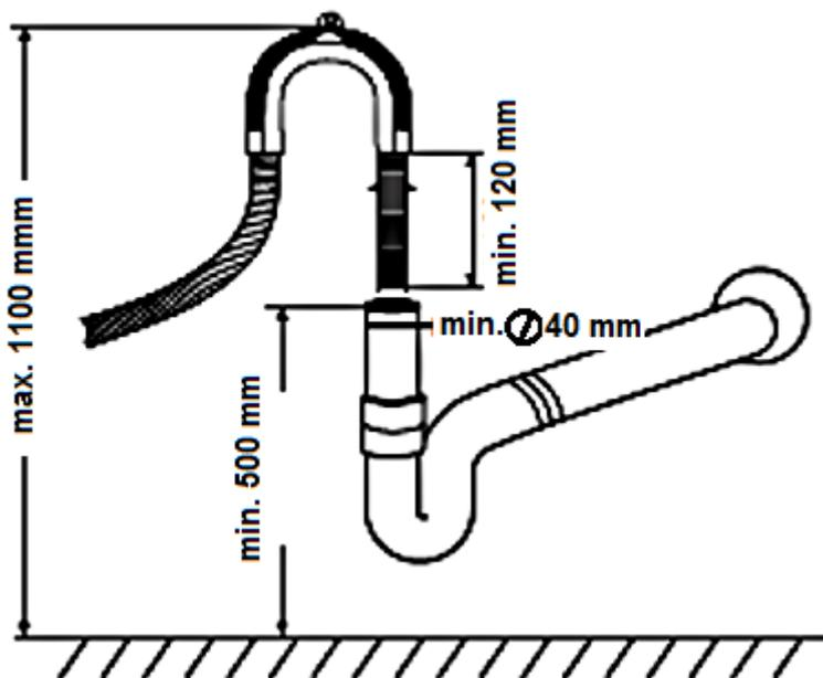
**Abwasserauslass.** Passen Sie den Ablaufschlauch gerade in den Wasserablaufstutzen ein. Falls die Länge des Ablaufschlauchs nicht ausreicht, könne Sie bei Ihrem autorisierten Kundendienst eine Verlängerung aus demselben Material wie das Original erwerben. Die Länge des Ablaufschlauchs darf einschließlich einer möglichen Verlängerung
