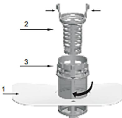
1. Der **Flächenfilter** fängt Rückstände mittels einer Spezialdüse am unteren Spülarm ein.
