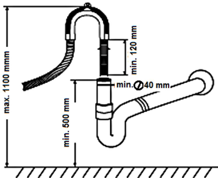
Passen Sie den Ablaufschlauch gerade in den Wasserablaufstutzen ein.
