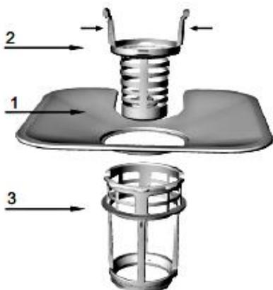
1. Der **Flächenfilter** fängt Rückstände mittels einer Spezialdüse am unteren Spüldarm ein.
