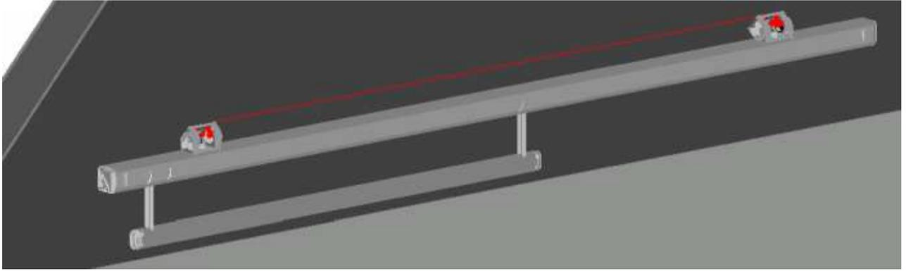
4.a. Laufschiene mit Kleiderstange an die Dachschräge halten und in die Waage bringen, Bohrungen anzeichnen und dem Untergrund entsprechend verschrauben.
