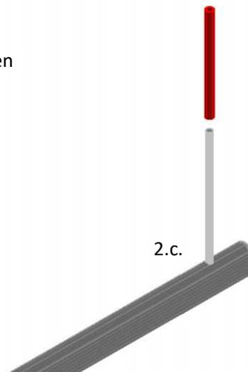
2.d. Schraubhülse in Laufwagen einführen
