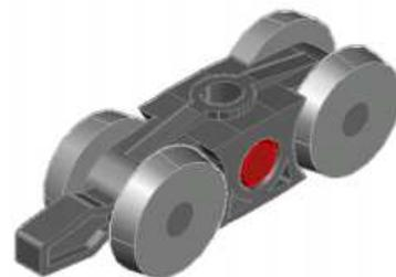
2.e. Gewindestange mit Laufwagen verschrauben. Die Aluminium-Hülse muss mit in der Führung des Laufwagens verschwinden. Laufwagen mit Kleiderstange leicht verschrauben, zu kräftiges Verschrauben kann das Gewinde beschädigen!
