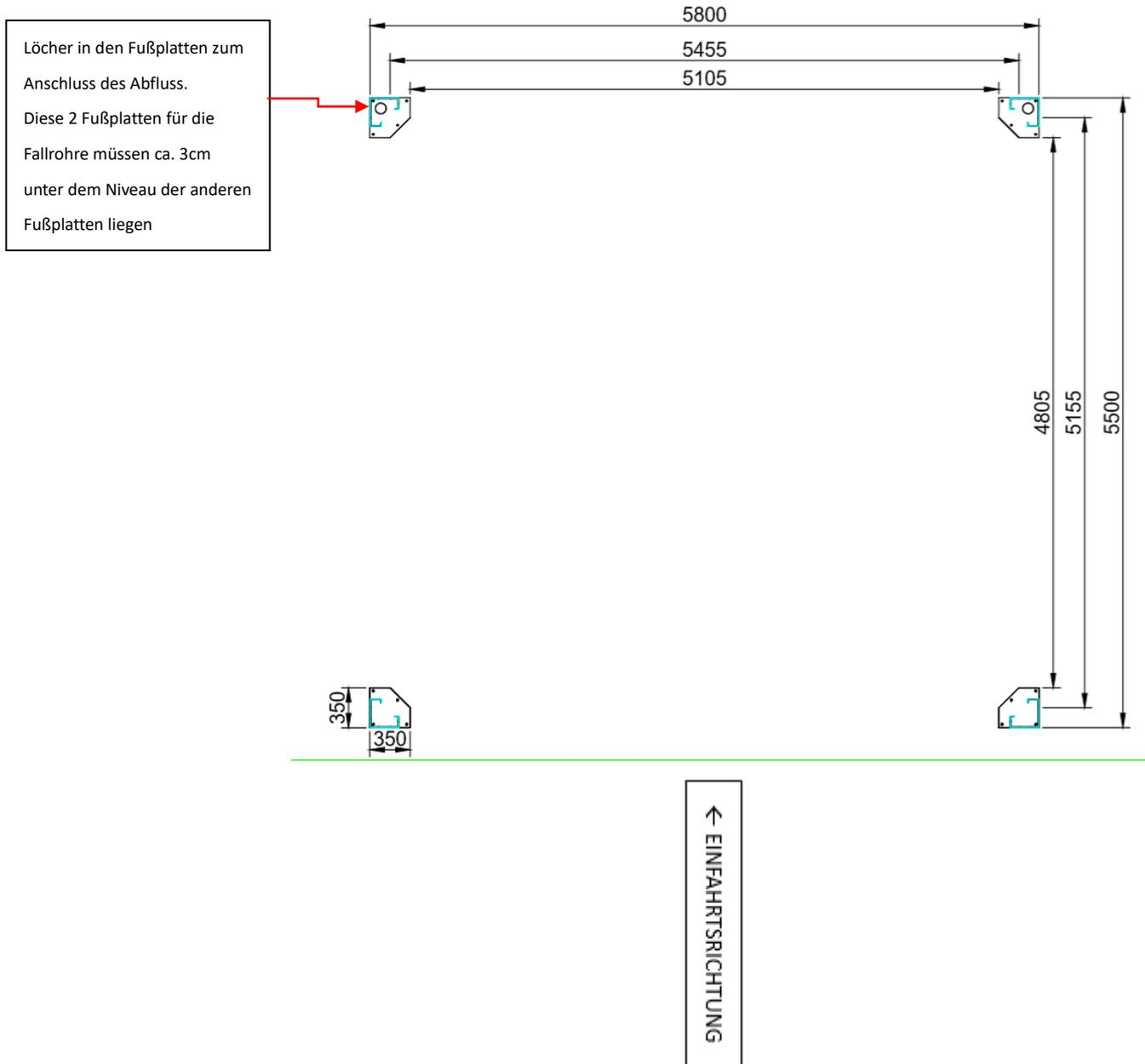
Das Fundament (minimum 50 x 50 cm Oberfläche ) gegossen, damit die Beine des Carports auf einem vernünftigen Areal befestigt werden können. Das Fundament muss bis in frostfreie Tiefe gegossen werden (min. 90cm).
