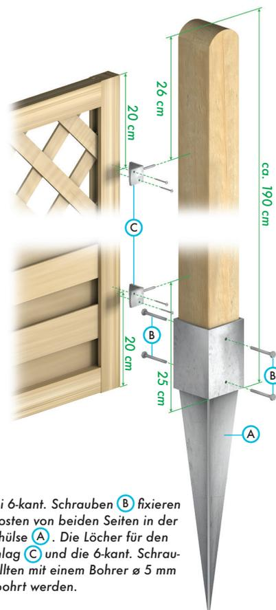
Je zwei 6-kant. Schrauben **B** fixieren den Pfosten von beiden Seiten in der Bodenhülse **A**. Die Löcher für den L-Beschlag **C** und die 6-kant. Schrauben sollten mit einem Bohrer  $\varnothing$  5 mm vorgebohrt werden.
