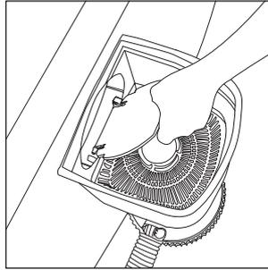
10. Den Saugergerät-Adapter über dem Sieb platzieren und nach unten drücken. Es wird ein Vakuum erzeugt, der für einen festen Sitz des Saugergerät-Adapters sorgt.
