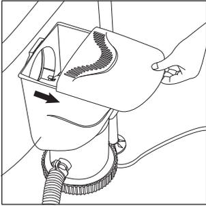
9. Bei der Summer Waves Abschäumerpumpe der SFX-Serie das Wehr aus dem Behälter entfernen.
