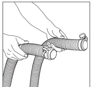
6. Den flexiblen 1 1/4" Schlauch mit dem Saugaufsatz verbinden und die Schlauchschelle anziehen.
