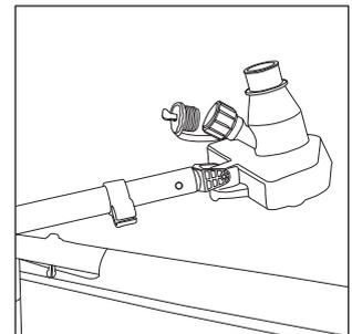
3. Die Abschäumerpumpe einschalten. Das Wasser beginnt, zum Pool durch die Rücklaufdüse zu fließen. Die Pumpe während des gesamten Ansaugprozesses eingeschaltet lassen.
