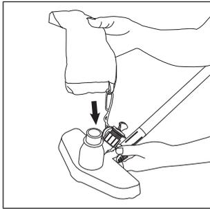
4. Die Wasserschlauchkappe abschrauben.
