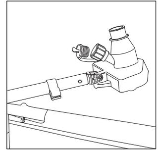
3. Den Beutel für angesaugten Müll mit dem Saugaufsatz verbinden, den Kordelzug festziehen und wie eine Schleife binden.
