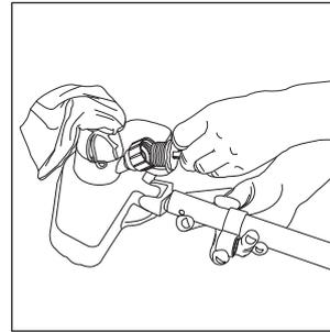
5. Einen 5/8" Gartenschlauch am Saugaufsatz per Hand anziehen.
