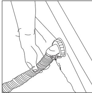
12. Mit dem Schlauchende unter Wasser das Ende des Schlauchs langsam durch die Abschäumeröffnung führen und anschließend mit dem Schlauchanschluss des Saugergerät-Adapters verbinden.
