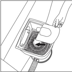
11. Das offene Ende des flexiblen Schlauchs mit der Rücklaufdüse verbinden und den Schlauch mit Wasser füllen. Den Schlauch so lange füllen, bis im Schlauch keine Luft mehr bleibt.
