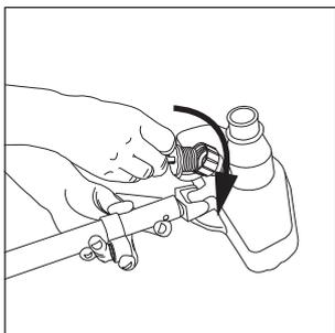
5. Die Schlauchschellen über die Manschette an den offenen Enden des flexiblen Schlauchs lose aufsetzen.
