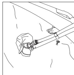
8. Die Wasserversorgung aktivieren. Dies sorgt für eine Venturi-Wirkung am Saugaufsatz, um Schmutz in den Beutel für angesaugten Müll zu leiten.
