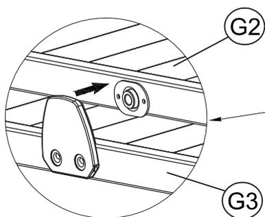
Um ein Verrutschen zu verhindern, muss das Dachelement G3 auf das Dachelement G2 geschoben werden, damit sich das ovale Eisenblech von Dachelement G3 (siehe Abbildung), mit dem Magneten von Dachelement G2 verbinden werden kann.
