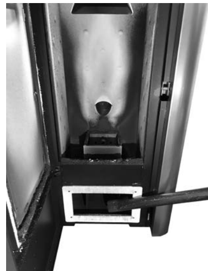
Fig. 33 - Die Asche absaugen
