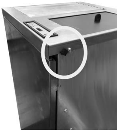
Fig. 25 - Abnehmen der Inspektionsabdeckung
